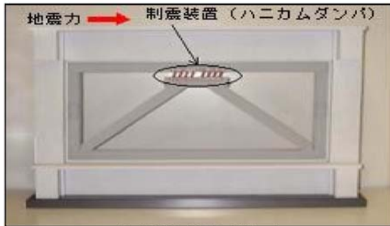
制震補強構面
