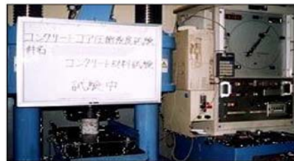
コンクリートコア圧縮強度試験
