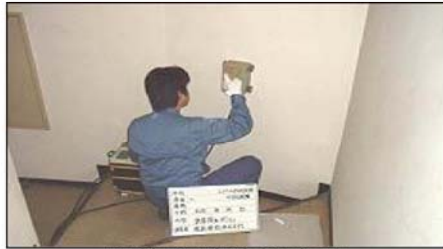
配筋非破壊検査法
